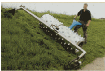
Tweewielige trekker met speciale noppen voor taluds
